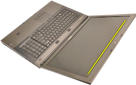
4. Подденьте лицевую панель дисплея с нижнего края и с обеих сторон и снимите лицевую панель дисплея.
