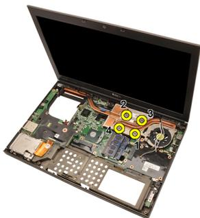
18. Приподнимите радиатор графического адаптера и извлеките из компьютера.
