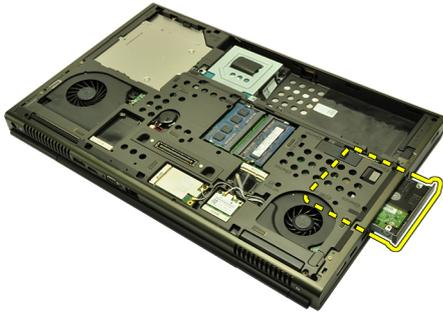
8. Отогните скобу крепления жесткого диска и нажмите на жесткий диск снизу вверх.
