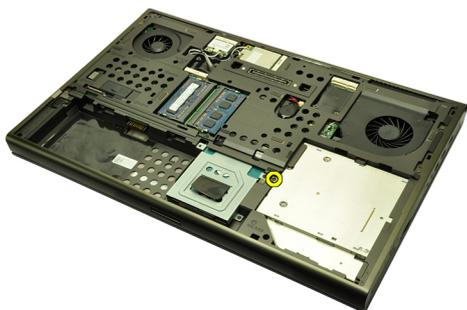
5. Извлеките оптический дисковод из компьютера.
