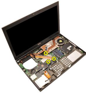
13. Приподнимите радиатор центрального процессора и извлеките из компьютера.
