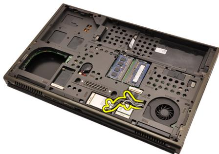
14. Протяните антенны через отверстие к верхней части компьютера.
