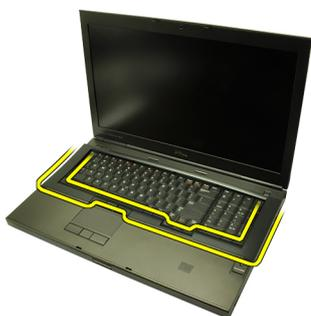
5. Приподнимите окантовку клавиатуры и снимите с компьютера.
