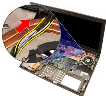
15. Отсоедините кабель вентилятора графического адаптера.
