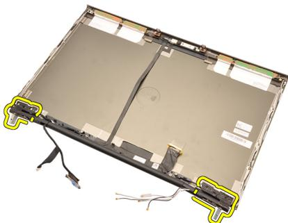
**16.** Высвободите опоры шарниров дисплея из кабелей и снимите опоры шарниров.
