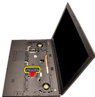
7. Осторожно разожмите фиксаторы модуля памяти.
