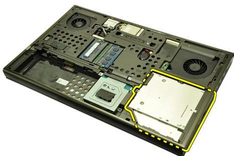
6. Выверните винты, которыми крепится скоба оптического дисковода.
