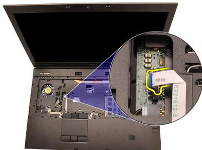
**15.** Отсоедините кабель считывателя идентификационных радиометок (RFID).
