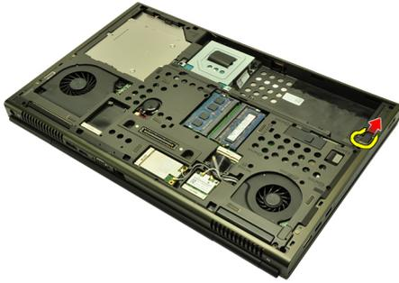
7. Извлеките каркас жесткого диска из компьютера.
