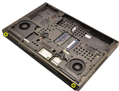
14. Протяните антенны через отверстие к верхней части компьютера.
