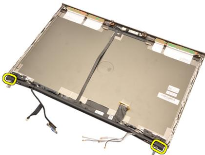
**15.** Снимите шарниры дисплея.
