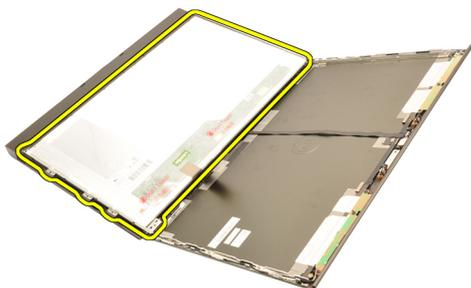
9. Выверните винты, которыми скоба дисплея крепится к панели дисплея.
