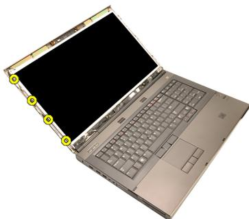
5. Выверните винты, которыми крепится панель дисплея.
