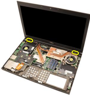
19. Снимите дисплей в сборе.
