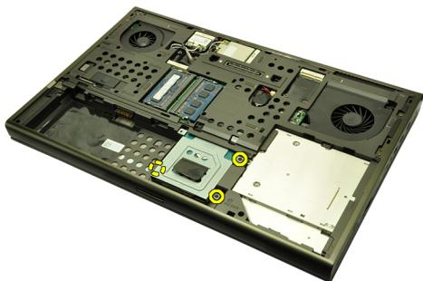
5. С помощью язычка потяните каркас жесткого диска вверх и извлеките его из компьютера.
