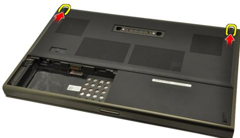
5. Снимите нижнюю крышку с компьютера.
