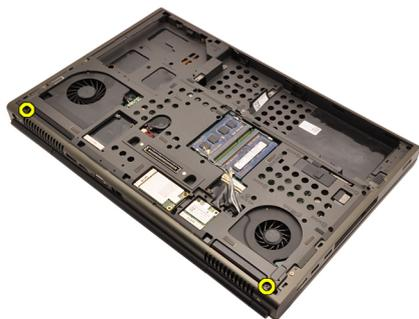
13. Выверните винты в задней части компьютера.
