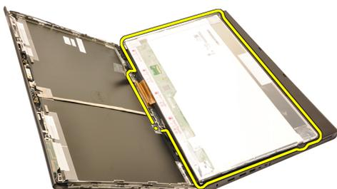
11. Выверните винты, которыми скоба дисплея крепится к панели дисплея.
