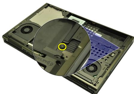
6. Сдвиньте защелку отсека жесткого диска в положение «открыто».
