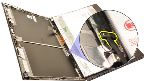
9. Выверните винты, которыми крепится кодирующий преобразователь.
