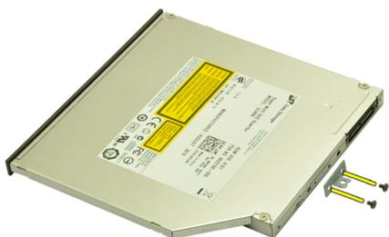
7. Снимите скобу с оптического дисковода.
