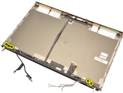
14. Снимите крышки шарниров дисплея.
