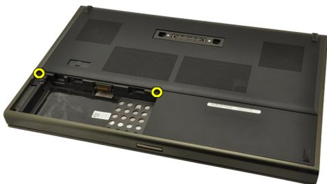
4. Нажмите на резиновые опоры и сдвиньте их в сторону задней части компьютера, чтобы высвободить нижнюю крышку.
